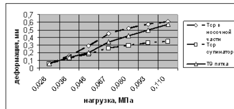
Рис. 1. Зависимость деформации стельки Viva от нагрузки в различных зонах
