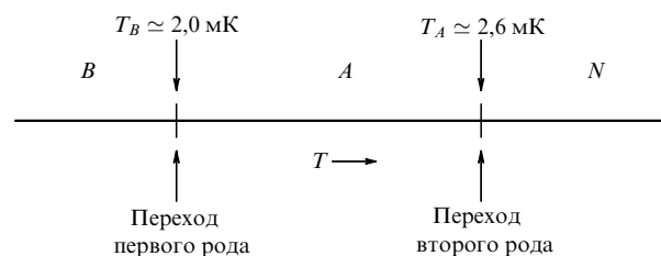
Рис. 1. Фазовая диаграмма жидкого ^3\text{He} при давлении плавления ниже 3 мкПа.
