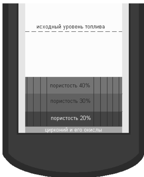
Рис. 4. Расчетная модель разрушенной активной зоны реактора ВВЭР-1000 на стадии засыпки керамических фрагментов ТВЭЛ
