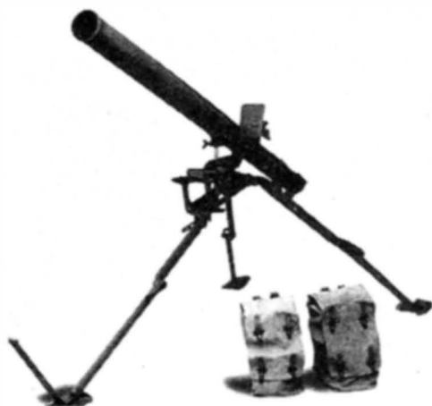
122-мм пусковая установка 9П132 «Град-П» («Партизан»)
