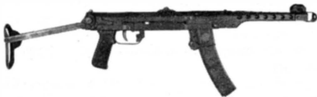
7,62-мм пистолет-пулемет ППС-43
