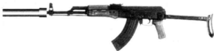
7,62-мм автомат АКМС-Л с прибором бесшумной стрельбы ПБС-1
