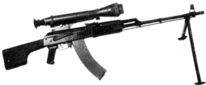
5,45-мм пулемет РПК-74Н с ночным прицелом НСПУ
