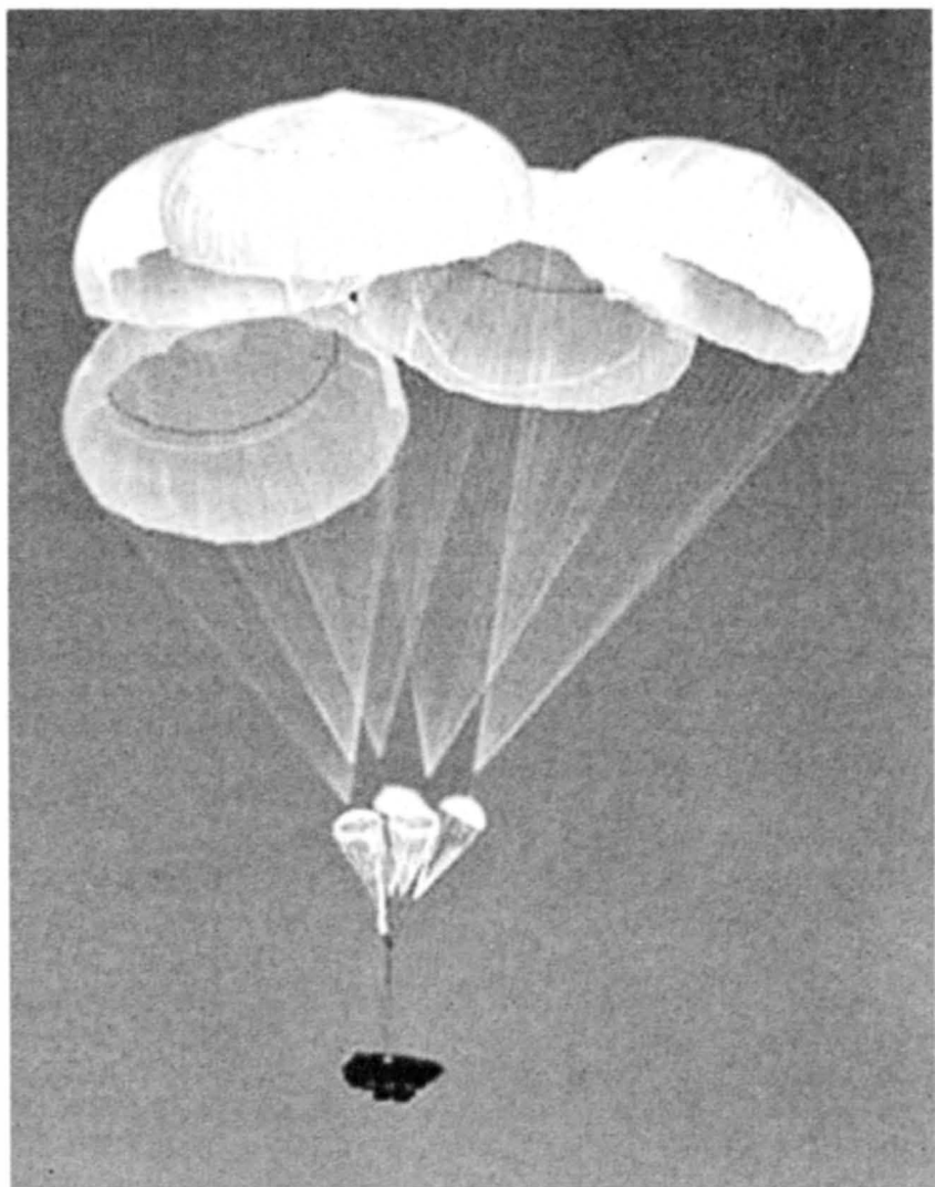
Многокупольная парашютная система МКС-5-128М
