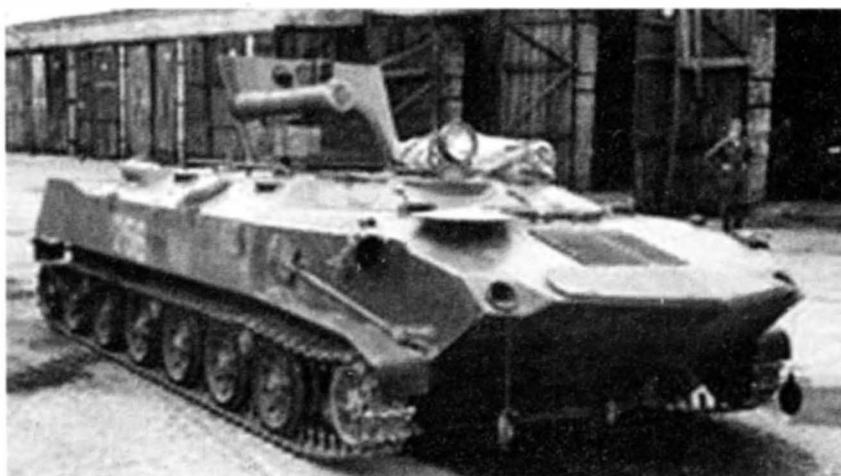
Десантный бронетранспортер БТР-РД «Робот» с ПТУР «Конкурс»
