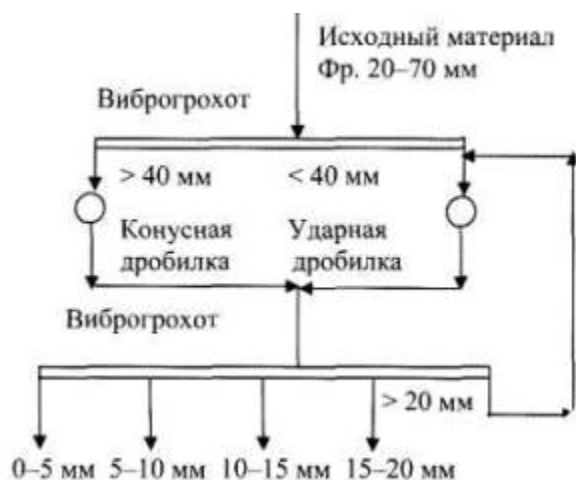
Рис. 3. Технологическая схема дробильно-сортировочной установки с использованием конусной и ударной дробилки
