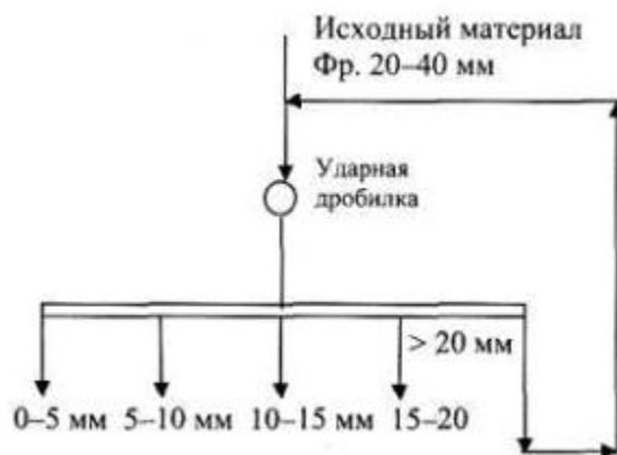
Рис. 4. Технологическая схема дробильно-сортировочной установки с использованием ударной дробилки
