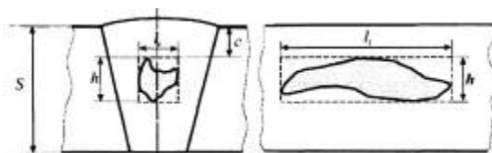
а) протяженный в кольцевом направлении дефект
